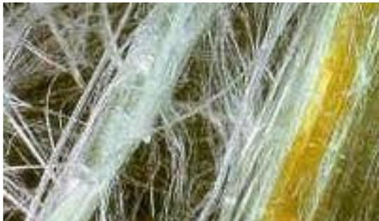
Les fibres d'amiante sont constituées de faisceaux de fibrilles qui se séparent très facilement sous l'effet d'usages, de chocs, de frottements... pour former un nuage de poussières très fines.
