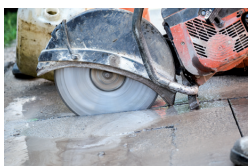
Machine avec système d'abattage à l'humide
