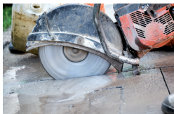
Machine avec système d'abattage à l'humide
