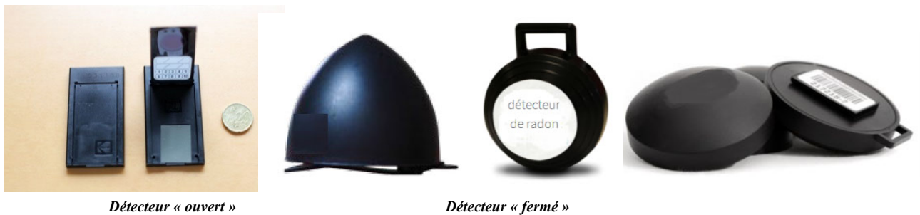
Figure 5 - Exemples de dispositifs de mesure intégrée du radon de type DSTN (Source Algade, Pearl, Radonova)
