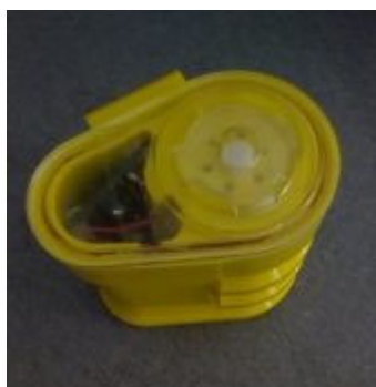
Figure 7 - Exemple d'un dosimètre individuel EAP (Source Algade)
